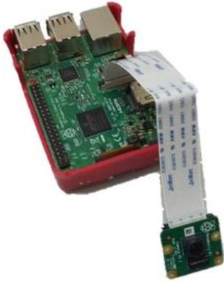
Fig. 1. Raspberry PI 3 associado a Raspberry Câmera compondo o Setup utilizado. Fonte: autor.
