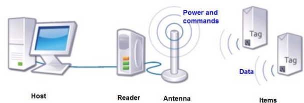
Fig.1. Configuração básica de um sistema de Identificação por Radiofrequência.
