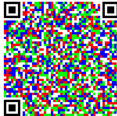
Fig. 7. CQR Code típico utilizado nos testes. Trata-se de uma imagem com dimensões 630 \times 630 pixels no formato bitmap codificada a 8 bits/pixels.
