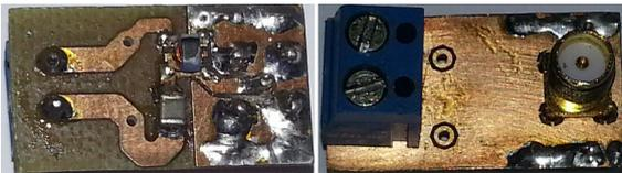
Fig. 2. Acoplador desenvolvido para medição da impedância de acesso à REE.
