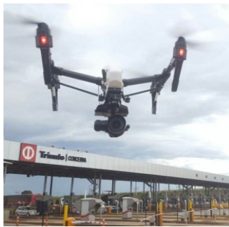
Fig. 1. VANT utilizado na aquisição das imagens. Ao fundo, imagem da praça de pedágio onde as imagens foram obtidas.
