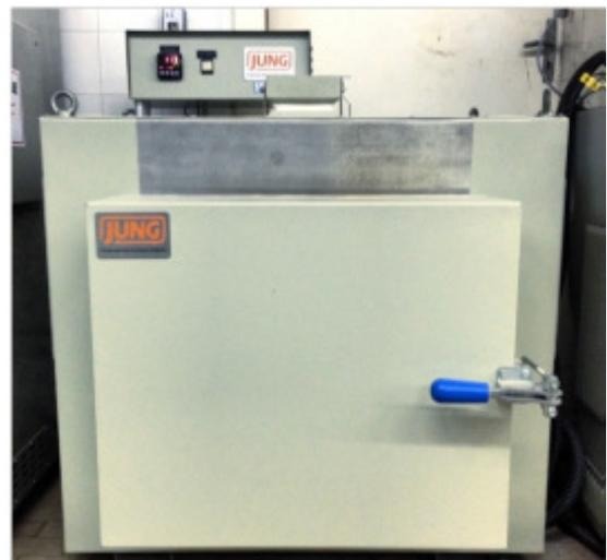
Fig. 5. - Forno resistivo da marca Jungle [15].
