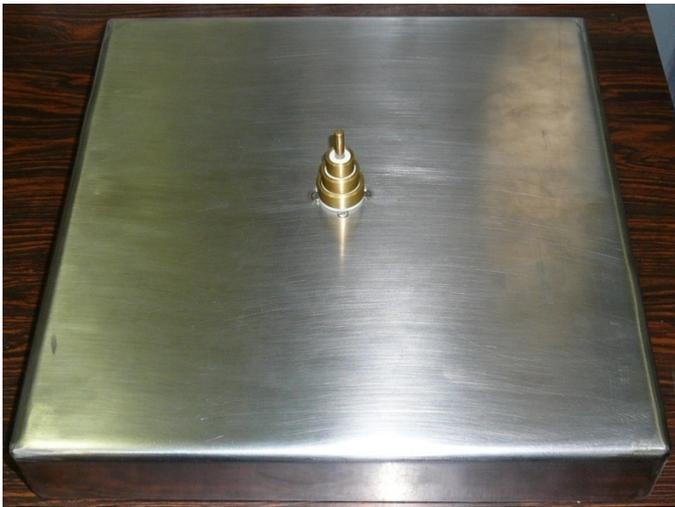
Fig. 6. Protótipo da antena monopolo com anéis parasitas cilíndricos.
