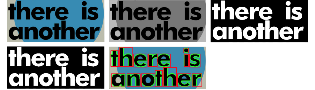
Fig. 7. Ilustração do processo de pré-processamento das imagens do banco: imagem original, imagem em escalas-de-cinza, imagem binarizada, imagem após dilatação, imagem original sobreposta com retângulos delimitadores dos caracteres.
