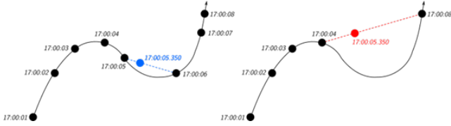
Fig. 3. Dois cenários de interpolação de coordenadas GNSS ao longo de uma trajetória: com dados contíguos (esquerda) e com dados faltantes (direita).
