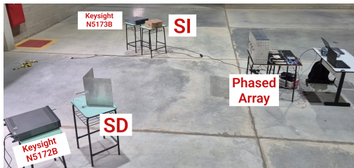
Fig. 7. Setup experimental para análise da capacidade de minimizar sinal interferente
