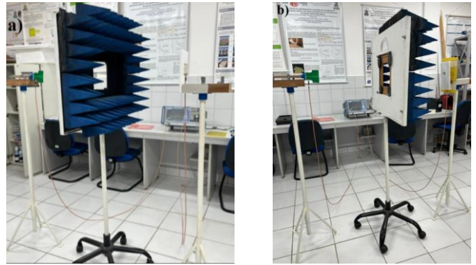
Fig. 10: Aparato de medição do S_{21} da antenna sem a FSS (a) e com a FSS (b).
