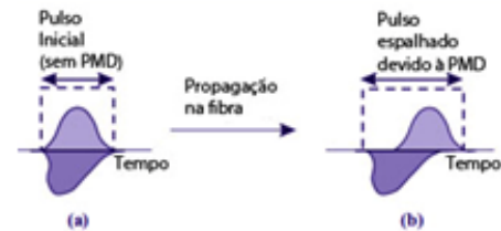
Fig. 1. Espalhamento de pulso devido à PMD.
