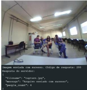
Fig. 4. Primeira resposta do servidor ao envio via ESP32-CAM. Figura do autor
