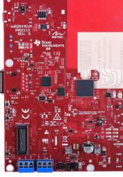
Fig. 3: Radar automotivo AWR2944 EVM da Texas Instruments. Esse radar possui um sensor de radar AWR2944 mmWave system-on-chip (SoC)[6].
