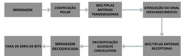
Fig. 2. Sistema de transmissão baseado em códigos polares e MIMO.
