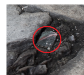
Fig. 13. Resultado da presença do pequeno pedaço de papel na superfície.
