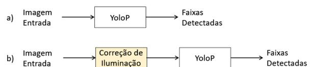
Fig. 1. a) Diagrama original do YOLOP. b) Arquitetura proposta com correção de iluminação.
