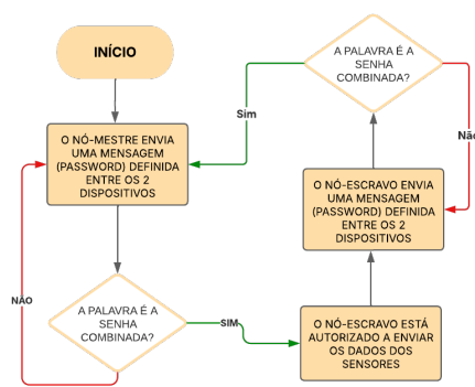
Fig. 1: Diagrama do protocolo mestre-escravo implementado entre os módulos LoRa.
