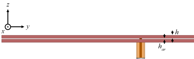
Fig. 3: Vista lateral da antena de microfita proposta com duas camadas de FR4. Adaptado de [11].
