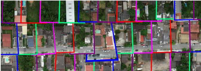
Fig. 6: Posicionamento de uma seção de vistas sobre  $I_M$ , com as bordas de cada imagem delimitadas. É possível notar diferentes acomodações para cada vista original, preservando a continuidade da imagem global apesar dos movimentos da plataforma.
