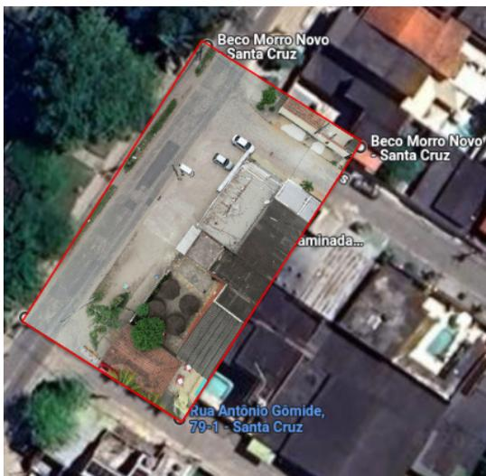
Fig. 9: Quadro do conjunto de dados (borda vermelha), sobreposto a imagem de satélite da mesma região. A conexão uniforme entre as áreas de asfalto do VANT e a imagem de satélite evidenciam o bom alinhamento e orientação do quadro sobreposto, apesar do ângulo não paralelo ao chão na imagem de satélite. A diferença na resolução e riqueza de detalhes da filmagem com o VANT também pode ser observada.
