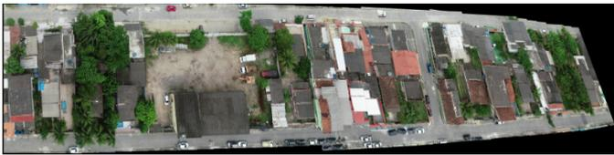
Fig. 3: Trecho do vídeo combinado através da composição de homografias. Apesar da costura suave, distorções tendem a se acumular, impedindo a combinação de intervalos mais longos.
