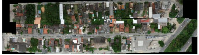
Fig. 1: Costura de quadros via correlação de fase. Apesar da aparente continuidade entre imagens, o modelo de translação não acomoda rotações, criando falsas disparidades. Eventualmente, a acumulação de erros leva a falhas visíveis entre passadas. A faixa preta na região superior da imagem revela um desvio nas estimativas de posição.
