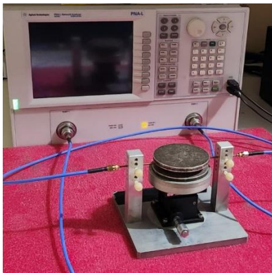
Fig. 1. Analisador de rede para medidas das propriedades em micro-ondas.
