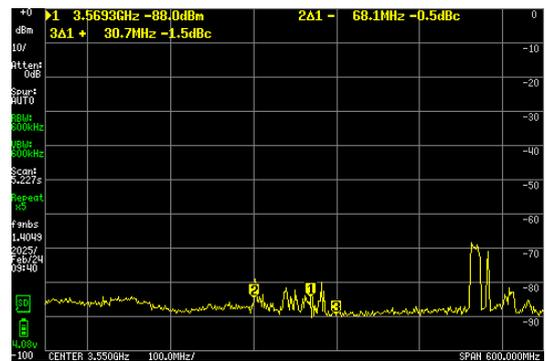
Fig. 5. Leitura com o analisador de espectro no ponto 55.
