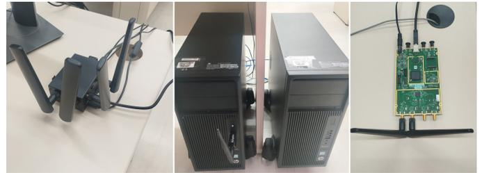
Fig. 3. Testbed real da rede 5G (UE à esquerda, servidores no centro e a RU do lado direito).
