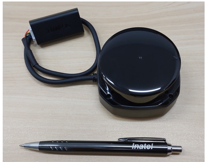
Fig. 1. Sensor LiDAR 2D RPLiDAR S2 fabricado pela SLAMTEC.
