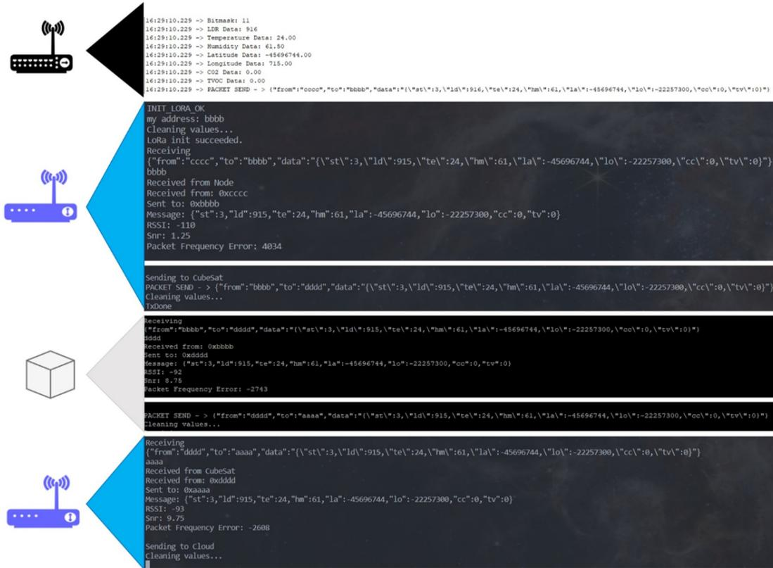
Fig. 6. Troca de mensagens através do protocolo LoRa durante o teste prático em solo.
