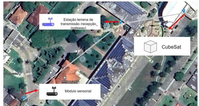
Fig. 5. Posição geográfica do módulo sensorial, da estação terrena/gateway IoT e do CubeSat para o teste prático em solo.
