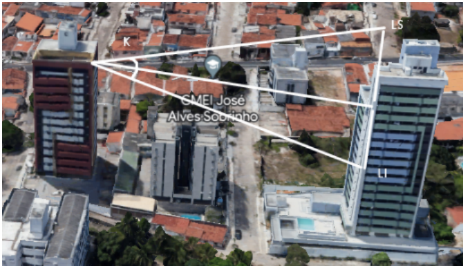
Fig. 2: Exemplo de demarcação da abertura vertical de meia potência de um azimute.
