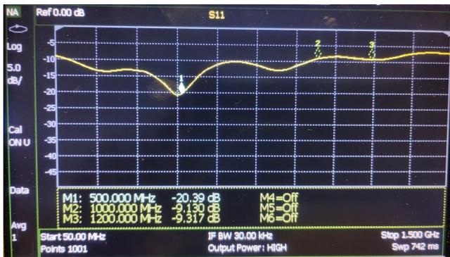
Fig. 12. Medida do parâmetro  $S_{11}$  do transformador de Klopfenstein.
