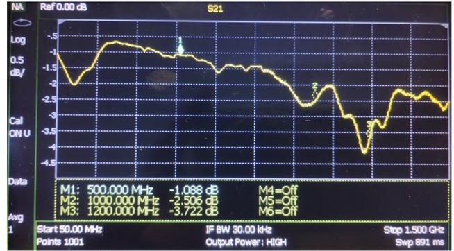
Fig. 8. Parâmetro  $S_{21}$  (dB) do transformador de quarto de onda de três estágios (2 transformadores).
