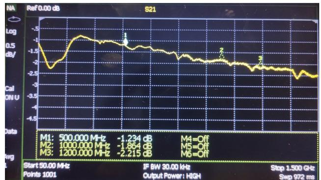
Fig. 9. Parâmetro  $S_{21}$  (dB) do transformador do tipo Klopfenstein (2 transformadores).
