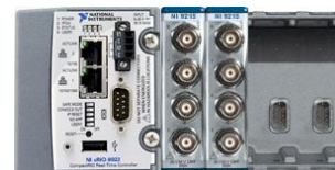
Fig. 2. Hardware da National Instruments (CRIO 9022, 9112 e 9234) utilizado para a implementação do sistema.
