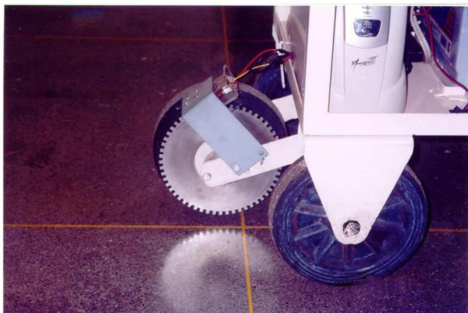
Fig. 3. Roda dentada e circuito amostrador.
