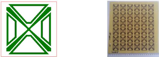
Fig. 17 FSS com banda dupla de operação para aplicações em WiFi, FSS4 – Célula unitária e FSS fabricada.
