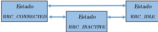
Fig. 2. Transições da máquina de estado [10].
