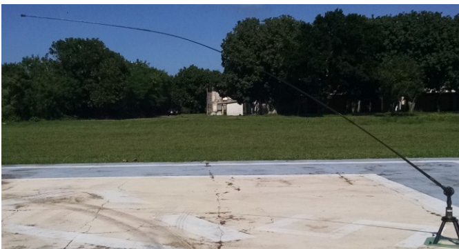
Fig. 3. Antena HF de 5 m inclinada a 40^\circ , sob ação da gravidade.
