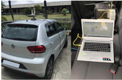
Fig. 2. Sistema de recepção: antena externa e equipamentos de recepção.
