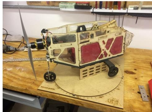
Fig. 1. Base giratória construída para a medição do diagrama de radiação.
