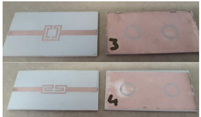
Fig. 11. Protótipos dos filtros 1 e 2 construídos.
