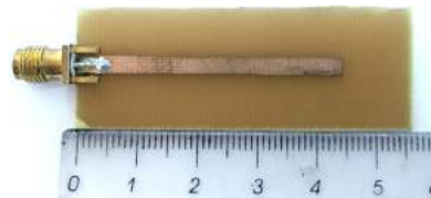
Fig. 2. Placa elaborada para determinar \epsilon_r do substrato.
