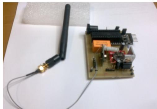
Fig. 6 – Módulo de aquisição e transmissão de dados em campo.
