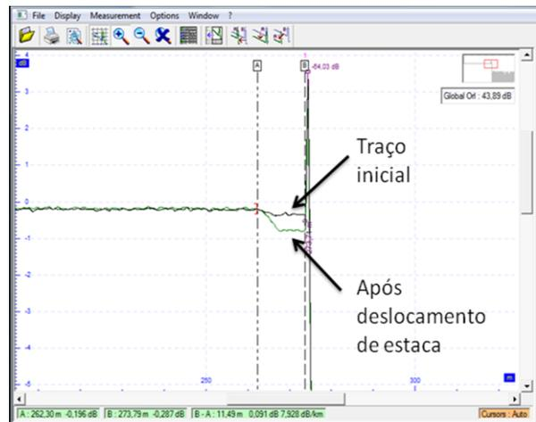
Fig. 8 – Traço observado no OTDR antes e depois do deslocamento.
