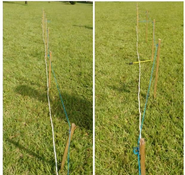
Fig. 5: Instalação para testes em campo. Na figura do lado esquerdo, estacas alinhadas espaçadas de 150 cm. Na figura do lado direito, estrutura após sofrer a deformação mecânica com três estacas deslocadas transversalmente de 20 cm ao alinhamento inicial.
