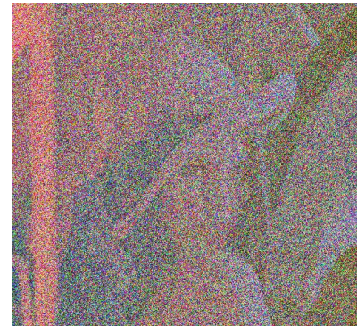
Fig. 5 – Imagem recebida em um canal AWGN com RSR de bit de 15 dB com ruído de fase e sem estimativa do ruído de fase.
