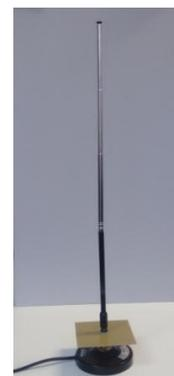
Fig. 3. Antena RH799 com plano terra usada no transmissor.
