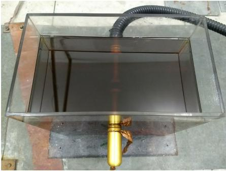
Fig. 4. Objeto de teste utilizado para a geração de descargas parciais.
