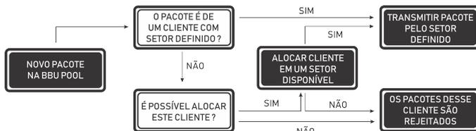
Fig. 2. Fluxograma de chegada de novo pacote
