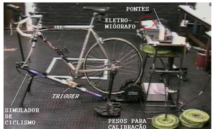
Fig. 3. Instrumentação utilizada para a digitalização de sinais de S-EMG em aplicações dinâmicas – simulador de ciclismo. No experimento também são adquiridos sinais de força aplicados sobre pedais instrumentados, mas não são objeto de estudo neste trabalho.
