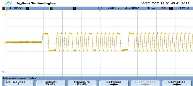
Fig. 08. Nível de tensão dos sinais recebidos pela UST
