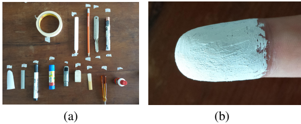
Fig. 5. Materiais utilizados para gerar o conjunto de teste: (a) fita adesiva (enrolada em dedo real para causar oclusão), vela (suas duas extremidades foram capturadas), um lápis de escrever (duas extremidades capturadas), um removedor de clip (ambas as extremidades capturadas), uma pilha, um cartão de papel enrolado, um pedaço de copo plástico, um conjunto de clips, uma caneta de quadro branco, uma cola de bastão, uma boquilha de metal de saxofone soprano, uma borracha, uma palheta de bambu de saxofone soprano numeração 2 1/2, uma chave de fenda e uma embalagem de corretor. (b) é um dedo ocluído com o uso de tinta branca.
