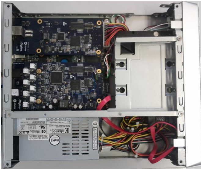
Fig. 6. Foto das três placas desenvolvidas montadas no gabinete.
