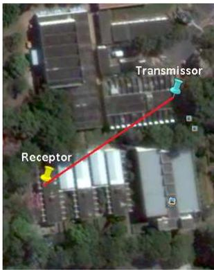
Fig. 1. Vista aérea do enlace FSO mostrando a localização do transmissor e do receptor no campus da Faculdade de Tecnologia.
