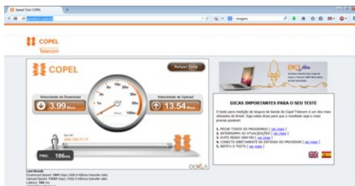
Fig. 5. Medição de velocidade obtida pela antena direcional de 3.99 Mbps de download e 13.54 de upload.
