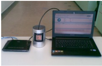
Fig. 3. Roteador D-Link, modelo DIR 618, utilizando a antena cilíndrica retangular.
