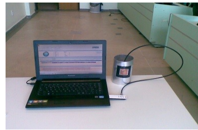
Fig. 6. Antena cilíndrica retangular diretiva utilizada para a recepção de sinal.
