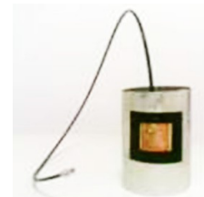
Fig. 2. Protótipo da antena cilíndrica diretiva
