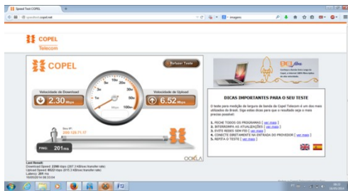
Fig. 4. Medição de velocidade obtida pela antena D-LINK de 2.30 Mbps de download e 6.52 Mbps de upload.
