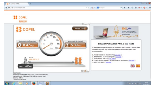
Fig. 7. Medição de velocidade obtida pela antena diretiva de 8.47 Mbps de download e 5.39 Mbps de upload.
