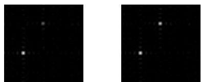
Figura 6. Fontes descorrelacionadas (ruído branco), geração dos sinais conforme seção III-B. Esquerda, K = 100 , L = 10 , direita, K = 100 , L = 100 .
