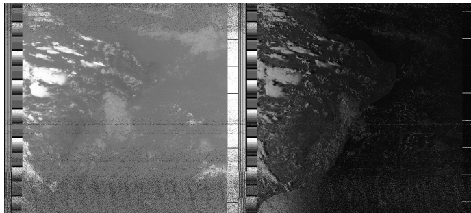
Fig. 14. Imagem recebida pelo receptor usando-se o dongle. À esquerda no espectro de infravermelho e à direita no espectro visível. Imagem recebida em 08/01/2015 às 04:25.
