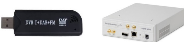
Fig. 6. Dongle Realtek RTL2832 (esquerda) e USRP N210 (direita).
