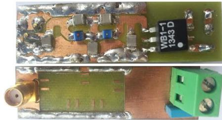
Fig. 4. Protótipo do acoplador PLC de 100 MHz.
